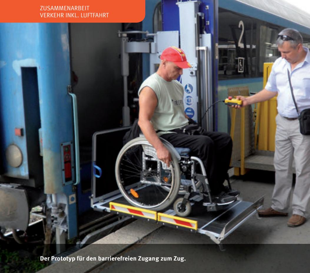
Der Prototyp für den barrierefreien Zugang zum Zug.
